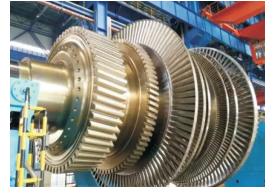
图 2 大型超临界发电机组实物图
