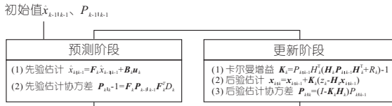
图 1 卡尔曼滤波器工作流程
