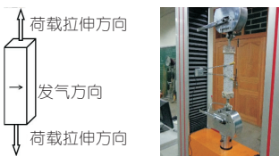
图 2 试件单轴拉伸试验的加载装置
