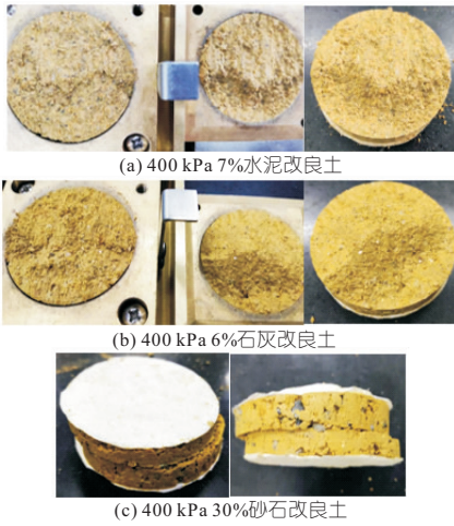
图5 不同改良土剪切试样破坏图
