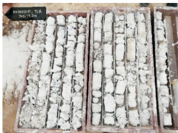
图 6 桩号 0+368 防渗墙芯样
