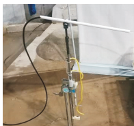
图 1 自制射流调节平台
