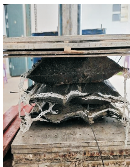
图 2 模袋体单轴抗压强度试验
