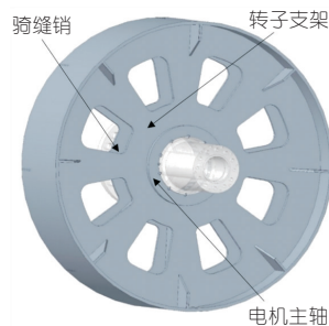
图1 转子支架与主轴联接方案示意图
