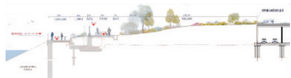
图 2 月亮湾堤防改造标准断面图
