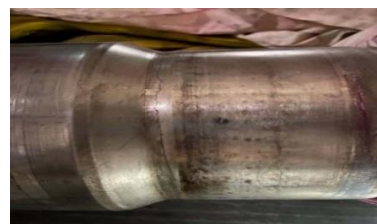
图9 风机转子裂纹示意
