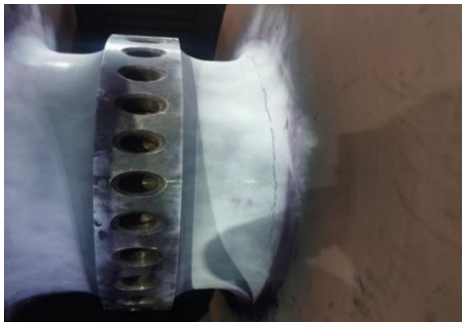
图 2 低压转子反向第 1 级进汽侧轮毂根部 R 角部位周向裂纹
