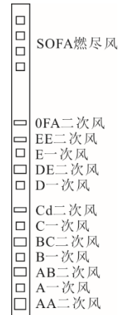
图5 锅炉燃烧器喷嘴布置
