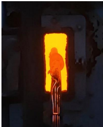
图 2 取样枪伸入炉内取样
