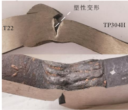
图 10 背弯开裂断口形貌
