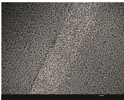
c) 4.0 mol/L硝酸浸出后银栅线
