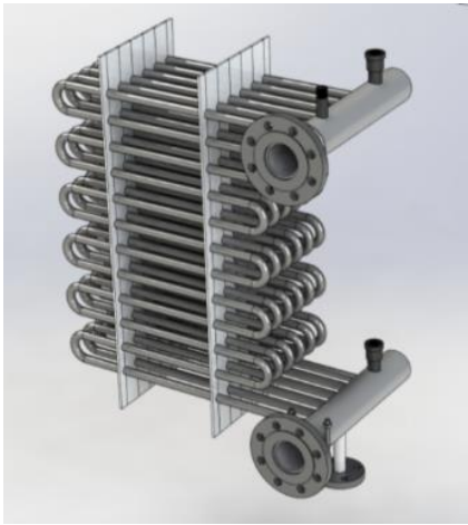
图 1 典型管束式换热器示意
