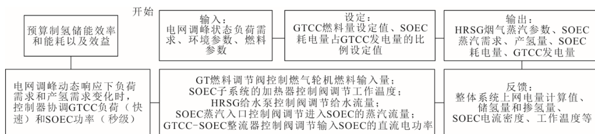
图 3 GTCC-SOEC 系统控制流程图
