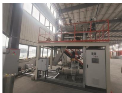
图 2 熔盐炭化炉小试装置实物 Fig.2 The bench-scale molten salt carbonization furnace
