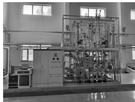
图3 10 t/a 碳捕集小试装置
