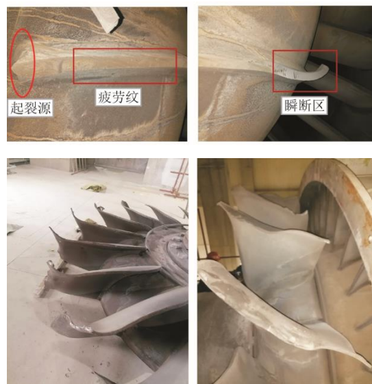
图 2 叶片断裂
