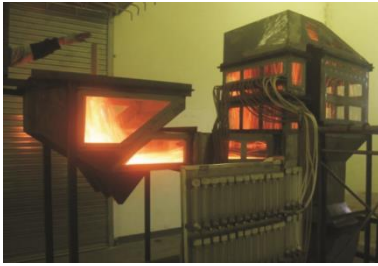
图 2 SCR 脱硝装置物理模型试验台
