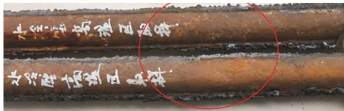
图 1 腐蚀样管向火面形貌
