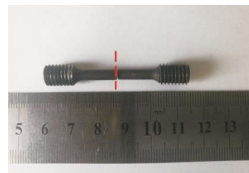
b) 750 °C 下焊态接头拉伸试样断裂外观
