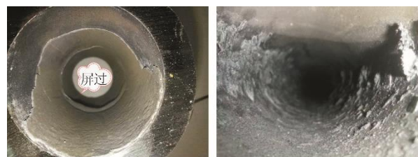
图 3 过热器、再热器管内积盐情况
