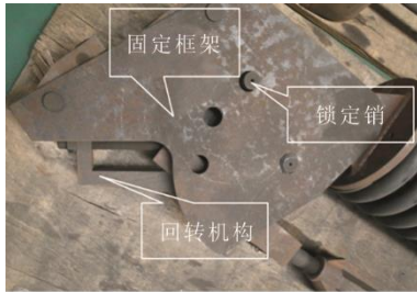
a) 锁定孔与销间隙情形1
