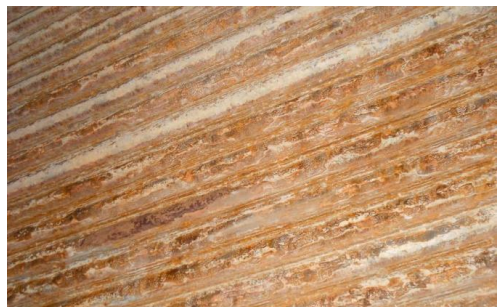
图1 侧墙水冷壁高温腐蚀
