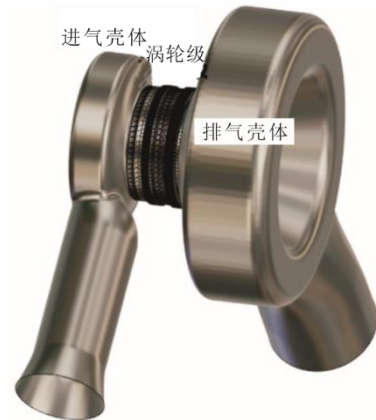
图 1 透平整机模型 Fig.1 The turbine model
