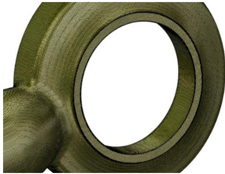
图 3 进气壳体网格 Fig.3 The inlet housing mesh
