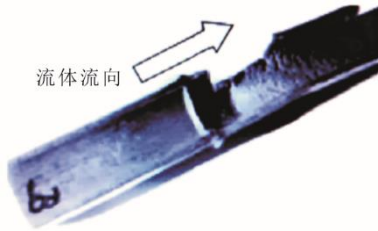
图 18 某厂高压加热器管段焊缝后腐蚀管样
