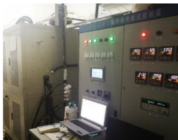
图 13 S-CO 2 传热与流动性能测试平台
