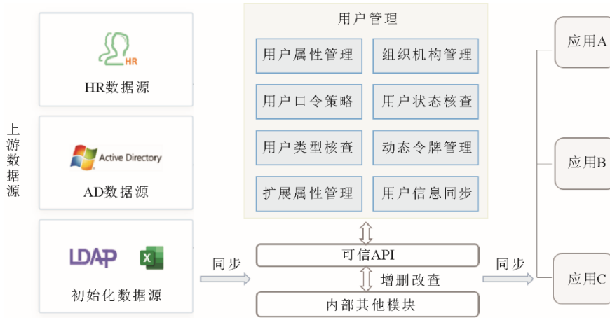
图 3 用户管理模块示意 Fig.3 Schematic diagram the user management module
