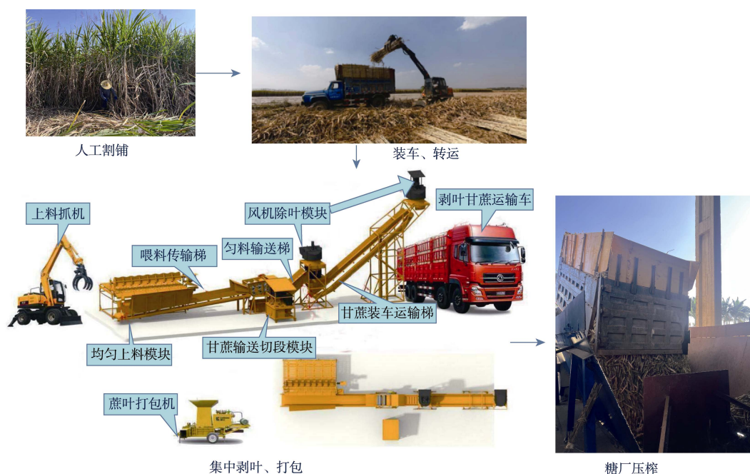
图 1 甘蔗分步式机械收获模块解析
