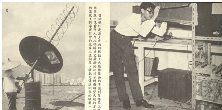
图 24 天文台人员在 20 世纪 60 年代于京士柏高空气象站利用自行研发的简单仪器接收美国气象卫星云图
