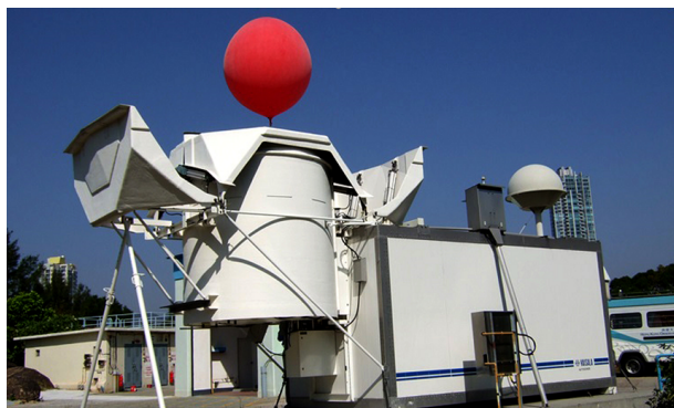
图 22 京士柏气象站的全自动高空探测系统在 2004 年启用,是当时东南亚首台同类系统
