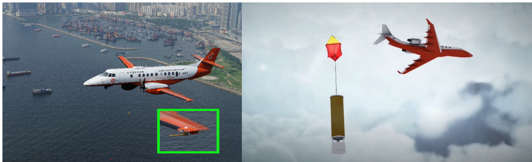
图25 自2011年起,香港天文台曾多次利用政府飞行服务队的固定翼飞机飞进中国南海的热带气旋中收集气象数据;新一代固定翼飞机更添置了下投式探空系统,提供垂直方向的气象数据
