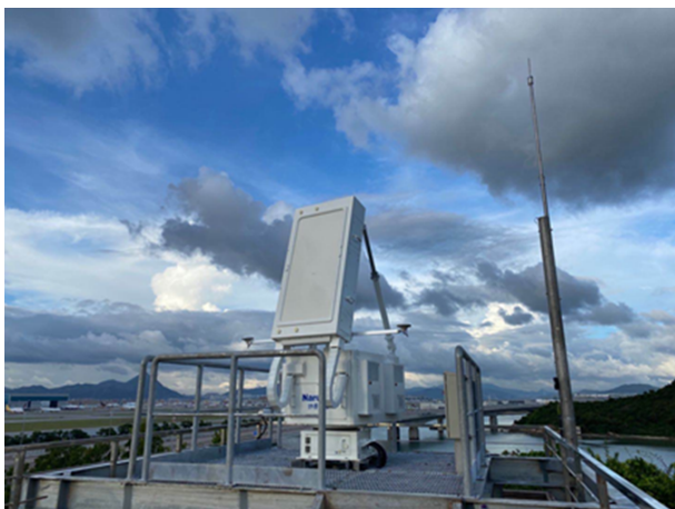
图 15 香港天文台于 2021 年在沙螺湾安装的首台相控阵天气雷达
