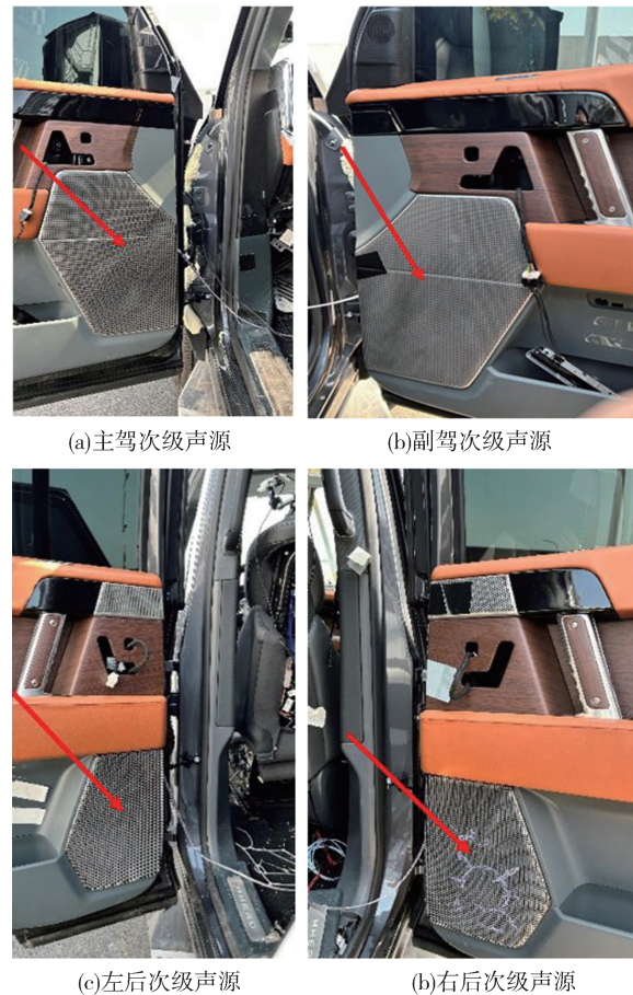
图8 车门次级声源布置图
