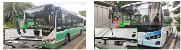
图 1 采集设备的安装位置
