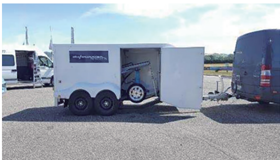
图1 道路六分力测试拖车
