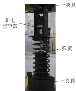
图5 试验实物布置
