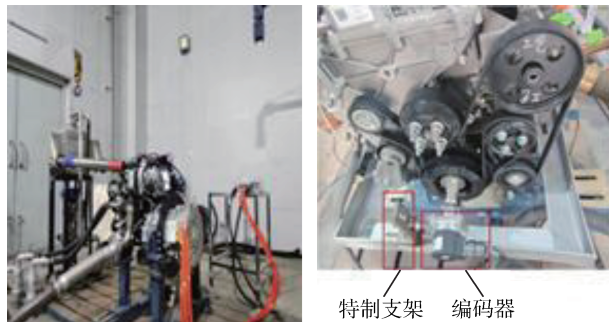
图7 台架实物及编码器安装位置图
