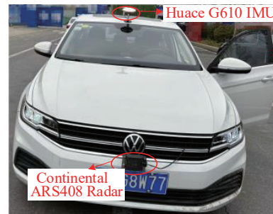
(a) 实车设备安装
