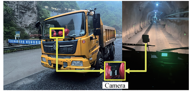
图8 数据采集所采用的无人实验车
