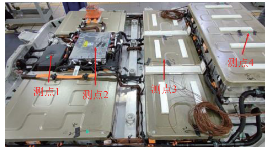
图8 实验中4个热电偶温度传感器布点
