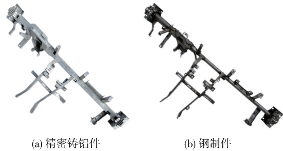
图9 精密铸铝及钢制仪表板横梁实物对比
