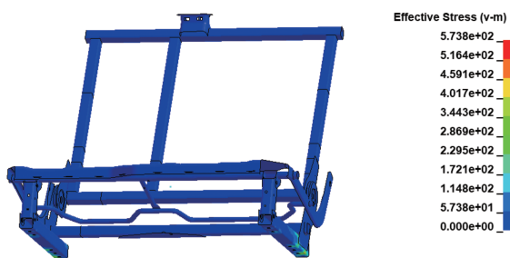
图6 座椅骨架仿真应力结果
