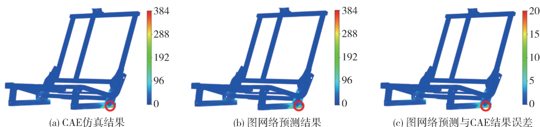
图10 座椅骨架网格泛化能力测试结果(单位:MPa)
