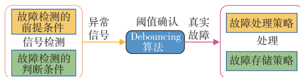
图1 ECU故障自诊断系统原理
