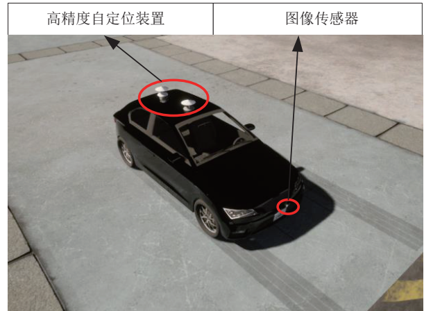
图4 智能网联汽车传感器搭载示意图
