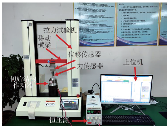
图15 力-位移特性实验现场装置
