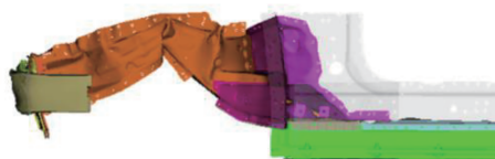
图13 CTB前部结构碰撞变形模式
