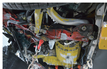
(c) CTB正碰电池包前部变形图
