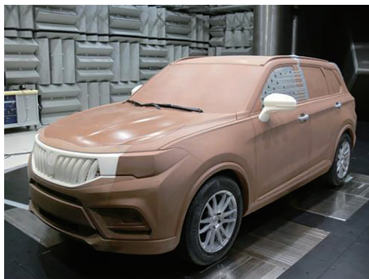
图1 油泥模型风洞试验
