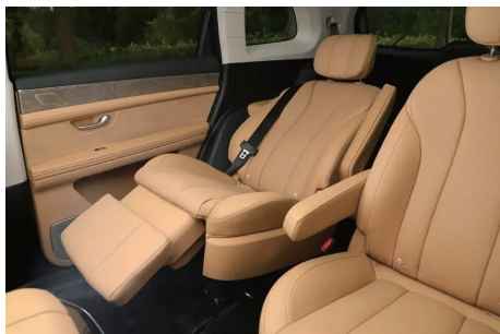
图1 汽车零重力座椅可大范围调整椅背和坐垫角度 (图片来自网络)
