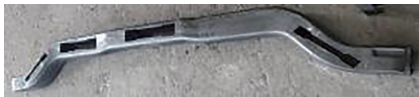
图13 切取单向拉伸试件
