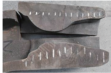
图5 无缝钢管成形时内部折叠
