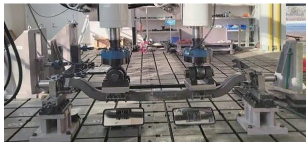
图21 空心前轴疲劳试验
