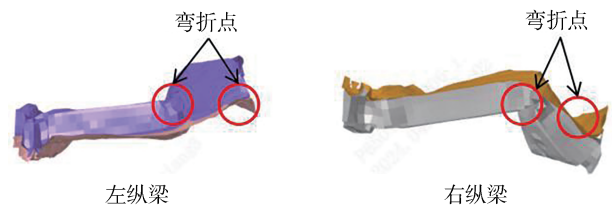
图6 丰田Yaris汽车正碰纵梁变形模式
