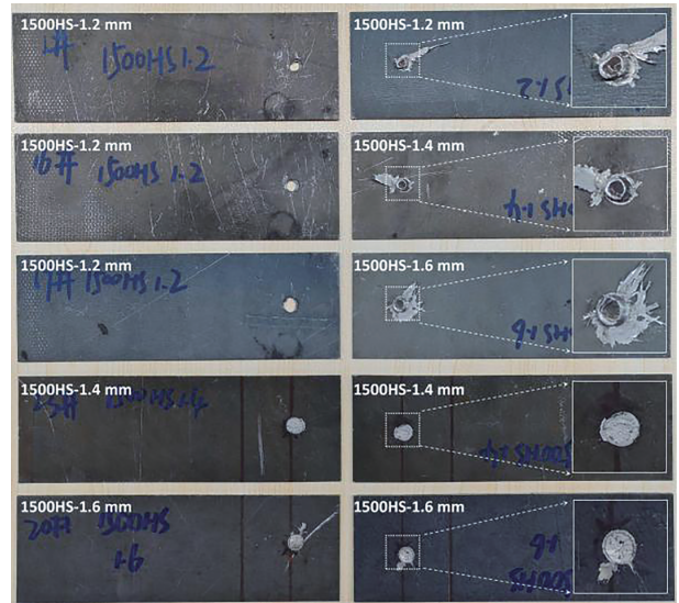
图 4 焊点试片断裂模式图
